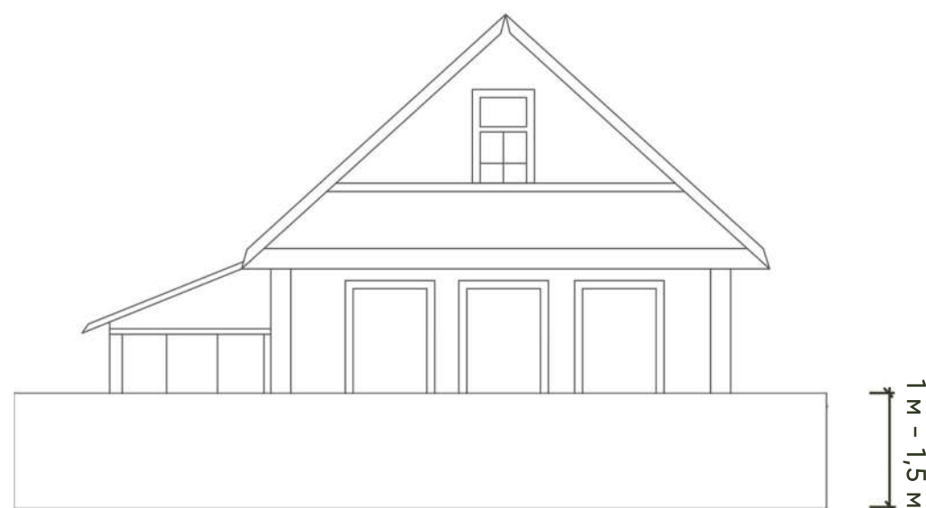
Плохо: Ограждение закрывает архитектуру фасада
